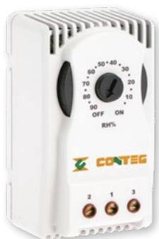
L'hygromètre est un appareil qui coupe ou active le module de chauffage de la baie en fonction du niveau d'humidité relative. En fonction du réglage du degré d'hygrométrie, le dispositif émet un signal de commande vers l'équipement de prévention de la condensation à l'intérieur de la baie.
