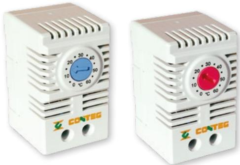
**Thermostat pour le refroidissement** (bouton bleu) : avec contact normalement ouvert : lorsque la température croît, le contact se ferme, activant le ventilateur pour évacuer la chaleur.
