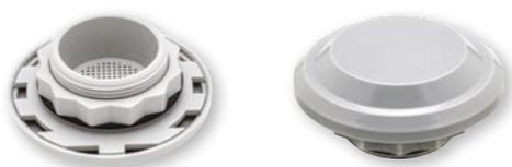
Lorsque des baies étanches sont exposées à des variations de conditions climatiques (installation à l'extérieur), de la condensation peut se former à l'intérieur du fait des différences de pression. L'ajout d'un compensateur de pression en plus de la membrane d'étanchéité intégrale évite dans une large mesure ces différences de pression et élimine donc la condensation. Cela permet en outre de prévenir la pénétration de l'humidité extérieure.
