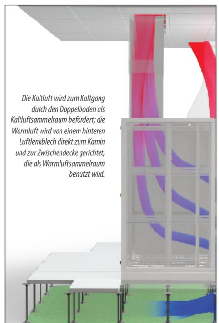
Die Kaltluft wird zum Kaltgang durch den Doppelboden als Kaltluftsammelraum befördert; die Warmluft wird von einem hinteren Luftlenkblech direkt zum Kamin und zur Zwischendecke gerichtet, die als Warmluftsammelraum benutzt wird.
