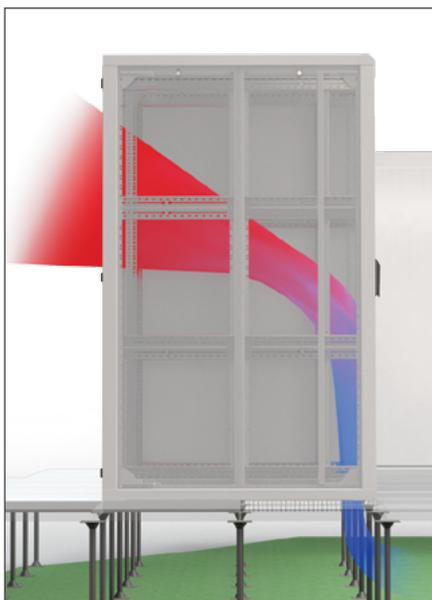
Kaltluft wird durch ein Luftlenkblech in die Kaltzone gerichtet. Die Kaltzone besteht aus einem Luftseparationsrahmen, Blindplatten und einer nicht gelochten Vordertür. Warmluft entweicht aus dem Schrank durch eine superbelüftete Tür.
