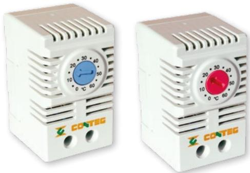
**Thermostat für die Kühlung** (blaue Taste): mit normalerweise offenem Kontakt; bei steigender Temperatur schließt der Kontakt und aktiviert den Lüfter, um die Wärme abzuleiten.
