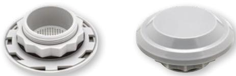
Insbesondere wenn die Gehäuse wechselnden klimatischen Bedingungen ausgesetzt sind (z. B. an Outdoor-Standorten), kann durch die Druckunterschiede auch in abgedichteten Gehäusen Kondensation auftreten. Die integrierte Sichtungsmembran verhindert deartige Druckunterschiede weitgehend und damit auch die Kondensation; darüber hinaus verhindert sie das Eindringen von Feuchtigkeit von außen.
