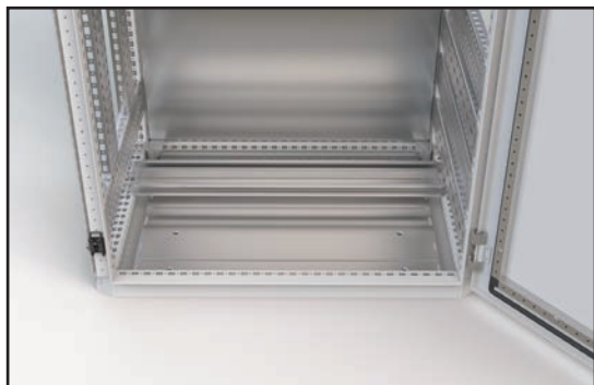
Un espace de 50mm du sol à l'embase de la porte permet une installation sans socle additionnel grâce à la base du cadre spécialement conçue. Cette solution ne réduit pas l'espace intérieur disponible.
